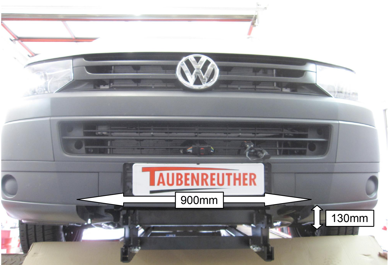
24 VW T5 ab 2010 und VW T6: Stoßfänger ausschneiden und montieren! VW T5 from 2010 and VW T6: Cut out bumper and mount it!
