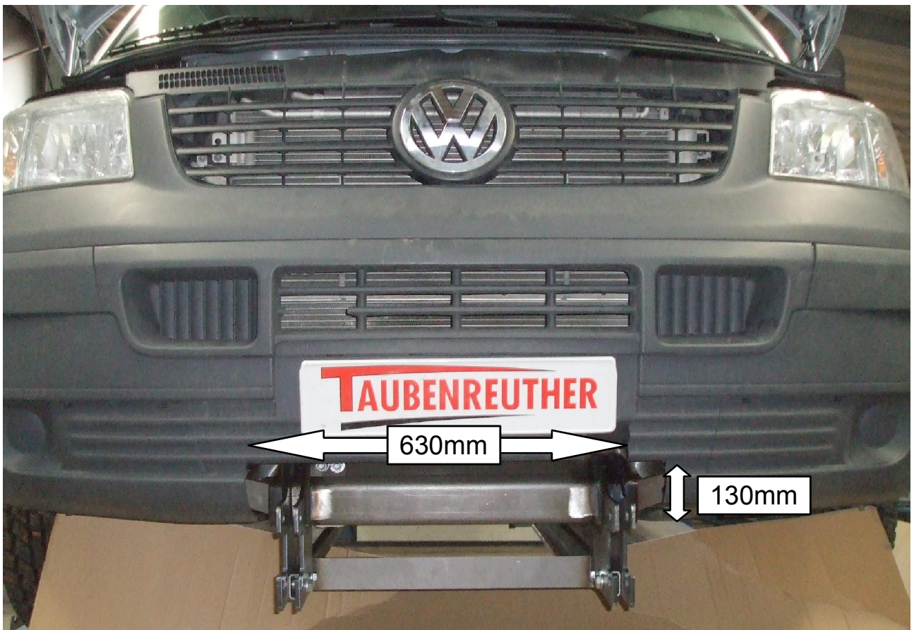
23 VW T5 bis 2010: Stoßfänger ausschneiden und montieren! VW T5 to 2010: Cut out bumper and mount it!
